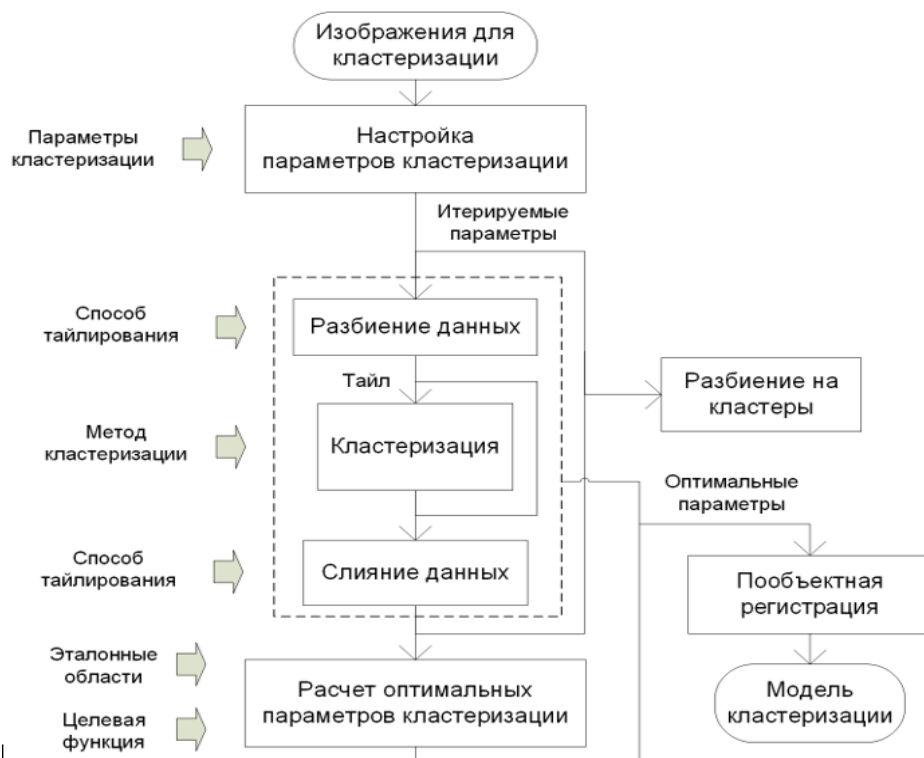
Рис. 3. Схема получения модели кластеризации.
