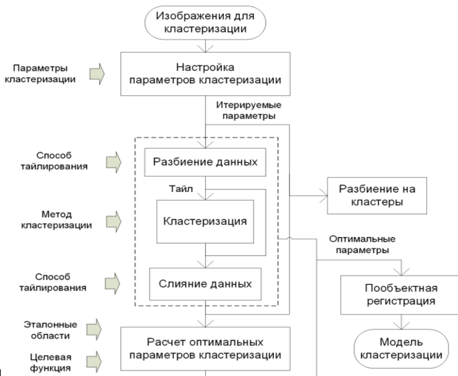
Рис. 3. Схема получения модели кластеризации.
