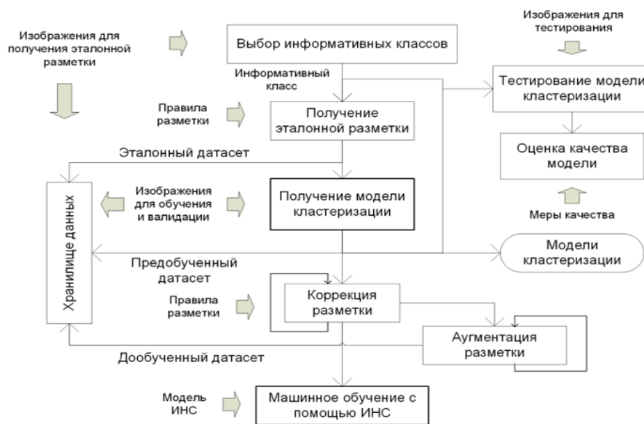
Рис. 5. Схема подготовки данных для машинного обучения (ИНС – искусственная нейронная сеть).
