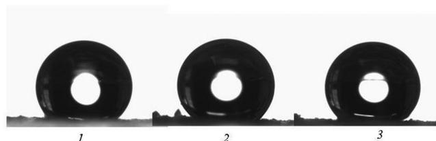
Рис. 4. Краевые углы смачивания облученных (300 кГр) порошков теломеров ТФЭ/ГФБ (1), ТФЭ/ПФХБ (2), ТФЭ/ПФББ (3).
