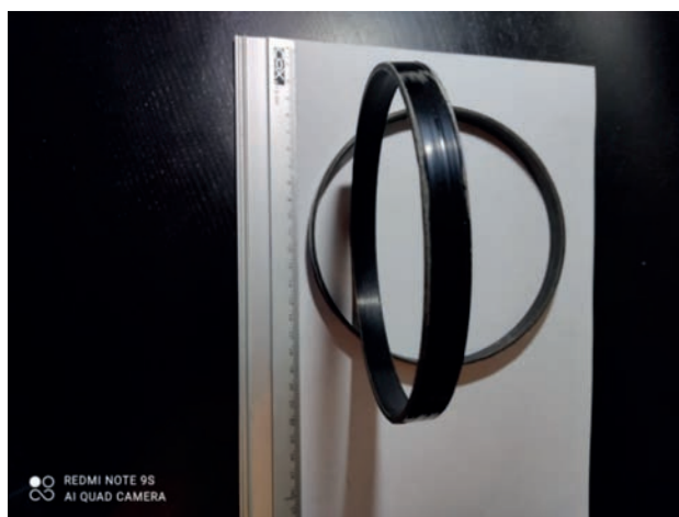
Рис. 1. Образец кольца из базальтового композитного материала.
