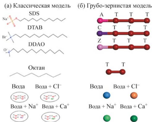
Рис. 10. Отличие двух моделей: а – атомистическое представление для классической МД; б – грубозернистое моделирование [28].
