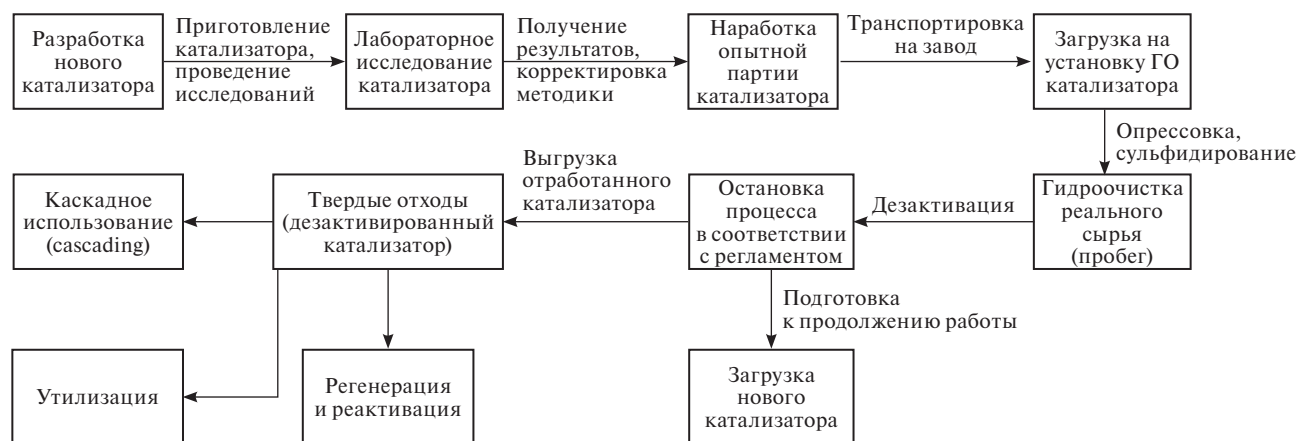
Рис. 1. Упрощенная схема «жизненного цикла» катализатора гидроочистки.
