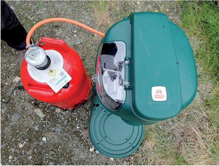
Рисунок 9. Углекислотная ловушка Mosquito Magnet. Фото Винсента Курта.
