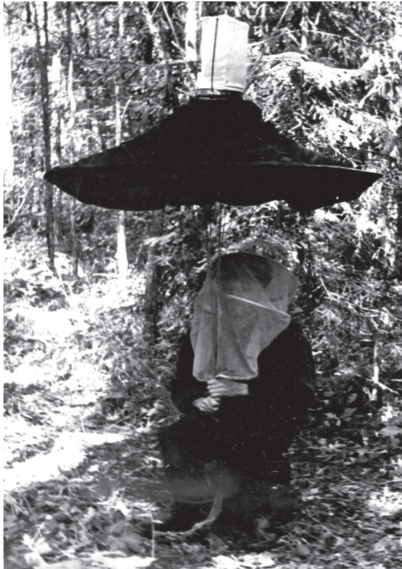
Рисунок 2. Колокол Березанцева для отлова кровососущих двукрылых насекомых. Фото Ю.А. Березанцева.
