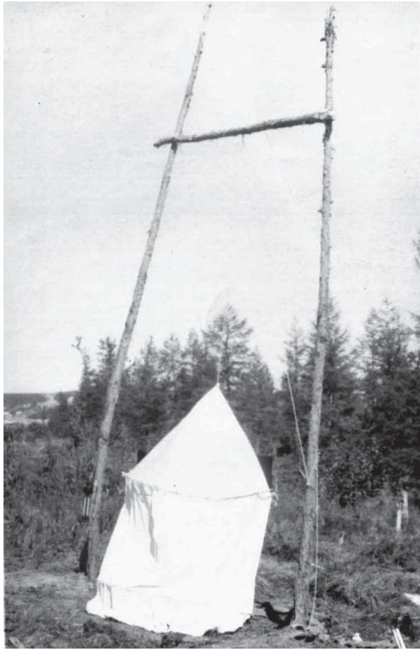
Рисунок 1. Колокол Мончадского для отлова кровососущих двукрылых насекомых. Фото А.Г. Мирзаевой.
