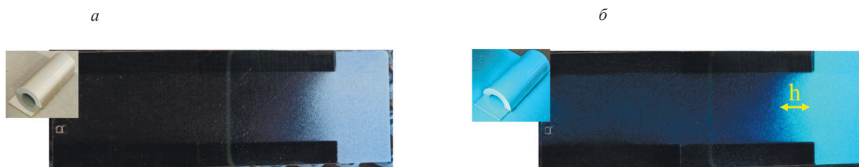
Рис. 6. Вид поверхности испытательного образца типа 1 по ГОСТ Р ИСО 3452—3 и ISO 3452-3 (образец яркости люминесценции) после нанесения на его поверхность люминесцентного состава на основе суспензионного типа проявителя при дневном (а) и УФ-свете (б).
