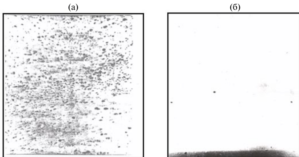
Рис. 4. Фотографии потока на входе (а) и выходе (б) волновой машины при концентрации твердых частиц в газе C_{\text{тч}} = 20 \text{ г/м}^3 , G_{\text{ж}} = 2 \text{ л/мин} , G_{\text{г}} = 0.097 \text{ м}^3/\text{с} , T_{\text{г}} = 290 \text{ К} .
