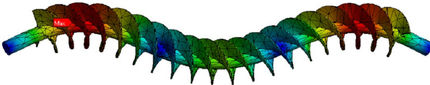
Рис. 5. Форма колебаний трехзаходного шнека с четырьмя шарнирными опорами на его низшей собственной частоте 565 Гц.
