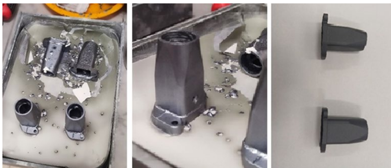
Рис. 2. Макет изделия сложной геометрии с резьбой.
