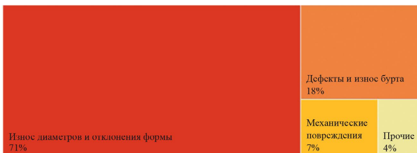
Рис. 1. Распределение по вероятности появления дефектов гильз цилиндров.
