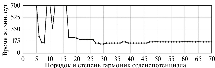
Рис. 5. Оценки времени существования на круговой полярной орбите с высотой 100 км над поверхностью в зависимости от порядка и степени селенопотенциала.
