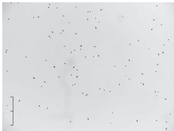
Рис. 2. Пример изображения частиц, извлеченных из разряда после левитации при следующих условиях: смесь гелия и ксенона в соотношении 85:15 при давлении 0.67 Торр и разрядном токе 1.5 мА. Частицы — кварц. Цена деления шкалы 10 мкм.
