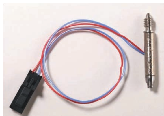
Рис. 1. Микрокапельный дозатор Microfab MJ-AB-01-40.
