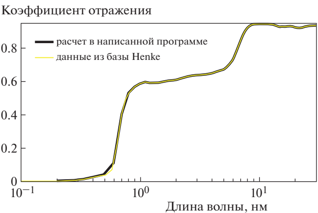
Рис. 2. Сравнение коэффициента отражения из базы данных CXRO с результатами расчетов, выполненными с помощью разработанной программной процедуры dDif. Две кривые полностью совпали друг с другом.
