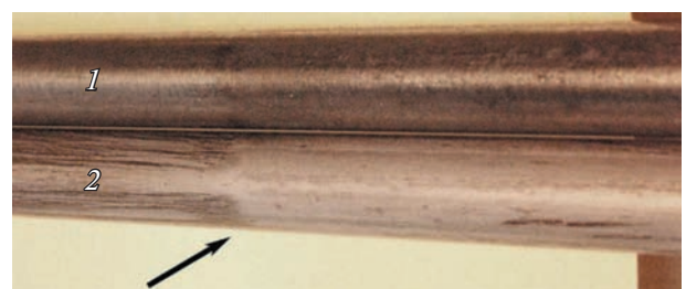
Рис. 14. Изображения рабочих поверхностей анода 1 и катода 2 после начала серии разрядов. Стрелкой показано место возникновения сильнотокового разряда. Острые шипы, инициирующие разряд в этом месте, удаляются. Направление ускоренного движения плазмы слева направо
