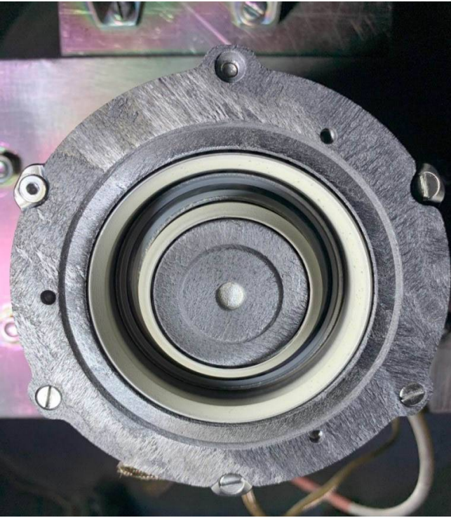
Рис. 33. Вид торцевой поверхности ЕМ НТ-1000 после 200-часовых эрозионных испытаний.
