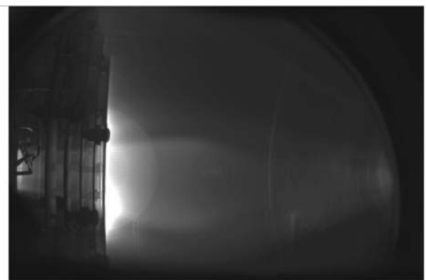
Рис. 4. Фотография свечения плазмы вблизи пушки, полученная с широкоугольным объективом при первичном обезгаживании ленгмюровских зондов разрядом. Обозначения: 1 — вид пяти колец входного плазмоприемника сбоку, канал разряда виден в зазорах между кольцами, 2 и 3 — ленгмюровские зонды на z = 0.20 и 0.54 м, 4 — переход к секции сильного поля. Прочие объекты правильной геометрической формы являются элементами конструкции камеры.
