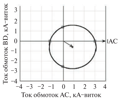
Рис. 2. Диаграмма пороговых токов в парах корректирующих катушек. Стрелкой показан вектор, определяющий величину и направление токов в парах катушек для коррекции ошибочного магнитного поля моды n = 1 .
