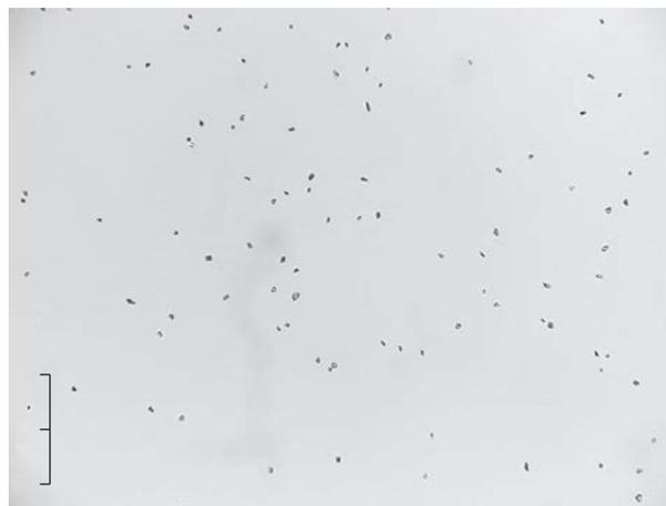
**Рис. 2.** Пример изображения частиц, извлеченных из разряда после левитации при следующих условиях: смесь гелия и ксенона в соотношении 85:15 при давлении 0.67 Торр и разрядном токе 1.5 мА. Частицы – кварц. Цена деления шкалы 10 мкм.
