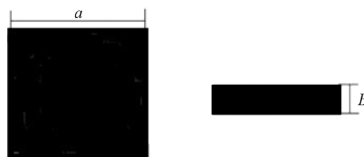
Рис. 3. Образец для измерения диэлектрической проницаемости.
