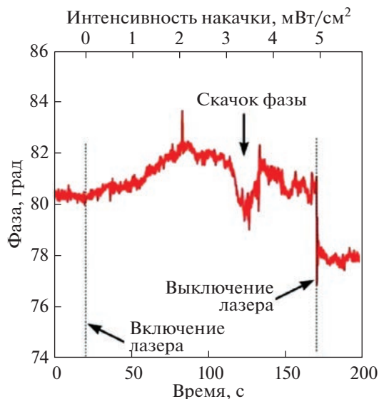
Рис. 2. Изменение сдвига фазы колебаний кремниевых зонда, находящегося над золотой подложкой, в зависимости от интенсивности накачки. Временная шкала коррелирует с интенсивностью накачки.
