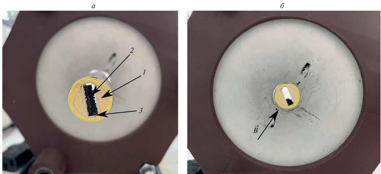
Рис. 4. Прототип, демонстрирующий принципиальную работу магнитоуправляемого клапана: 1 — пластиковое основание клапана, 2 — пористый BaFO/PDMS, 3 — закрепленный к основанию конец пористого BaFO/PDMS в закрытом состоянии (а) и в открытом состоянии при воздействии на клапан неоднородного магнитного поля, направление которого обозначено стрелкой (б).
