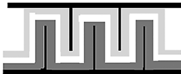
Рис. 2. 3D-конструкция с встречно-штыревыми массивами электродов.
