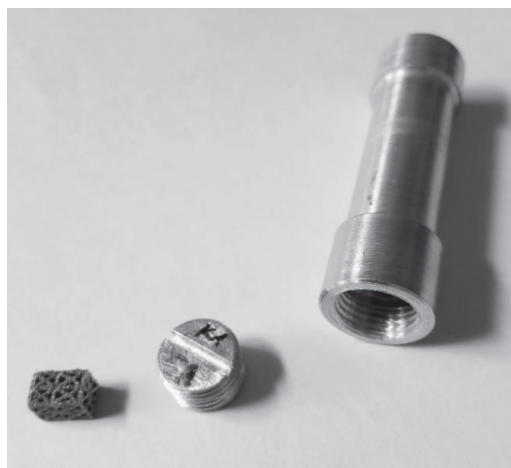
Рис. 4. Ампульное устройство для размещения источника в канале реактора
