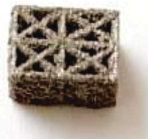
Рис. 3. Внешний вид каркаса источника для брахитерапии Fig. 3. External view of the implant of a brachytherapy source
