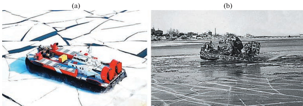
Рис. 7. Стадии разрушения ледяного покрова ИГВ: (а) – полное разрушение; (б) – достижение предела прочности льда на изгиб.
