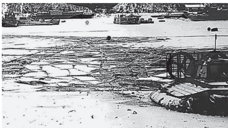
Рис. 5. Разрушение ледяного покрова СВП береговой охраны “Гепард”.
