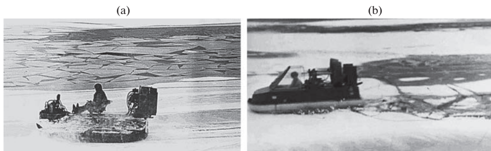
Рис. 3. Разрушение ледяного покрова крупномасштабными моделями СВП: (a) – “КНАПИ”; (b) – “Косатка”.
