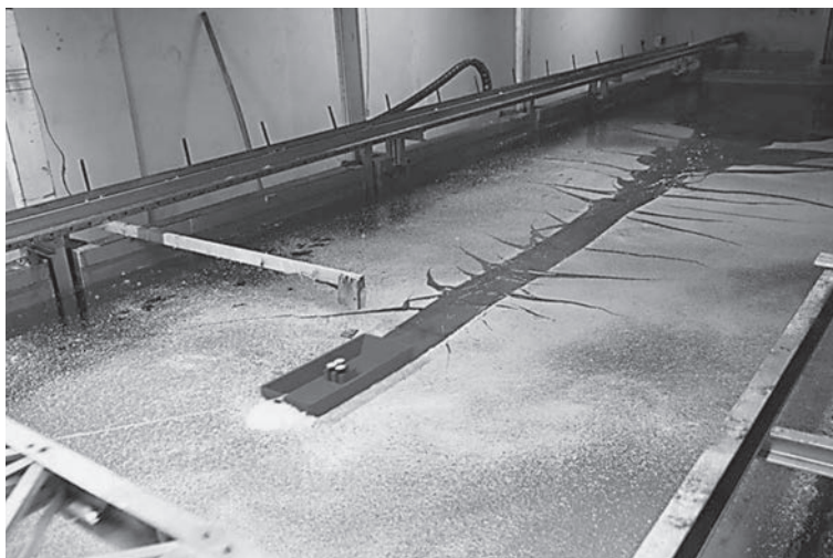
Рис. 1. Буксировка модели СВП в ледовом бассейне.
