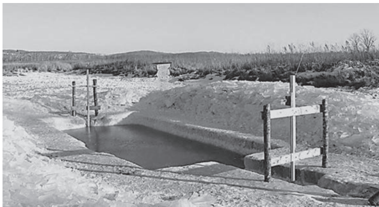
Рис. 2. Ледовый “бассейн” размерами 8.0 \times 3.0 \times 2.5 м, созданный в ледяном покрове озера толщиной 0.8 м.
