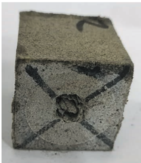
Рис. 1. Образец B5 с отверстием, соосным оси керна.
