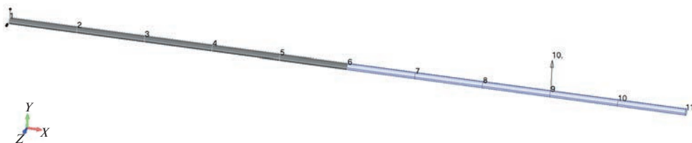
Рис. 1 – Модель балки. Показана нумерация узлов модели.
