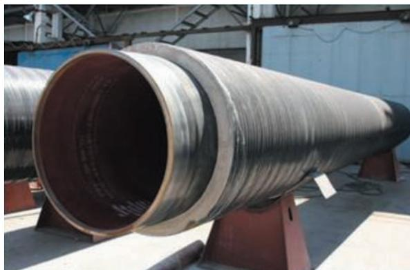
Рис. 1. Внешний вид обетонированной трубы.
