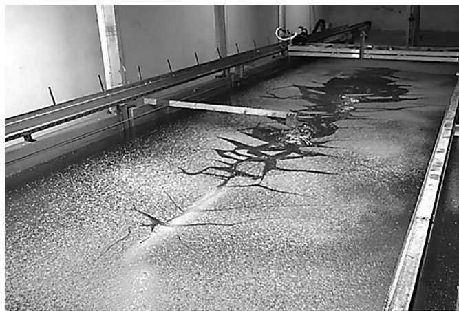
Рис. 5. Фрагмент разрушения сплошного ледяного покрова при движении модели подводного судна со скоростью Fg = 0.42 [7].
