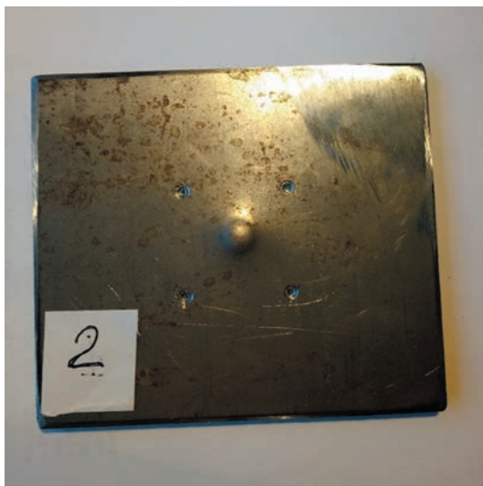
Рис. 4. Сплошная пластинка из стали после удара (эксперимент № 5).
