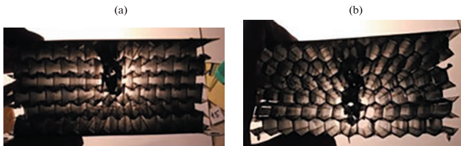
Рис. 2. Проникание ударника в ауксетический (а) и неауксетический (б) сотовые образцы в экспериментах № 1 и № 2.
