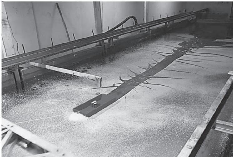
**Рис. 1.** Буксировка модели СВП в ледовом бассейне.
