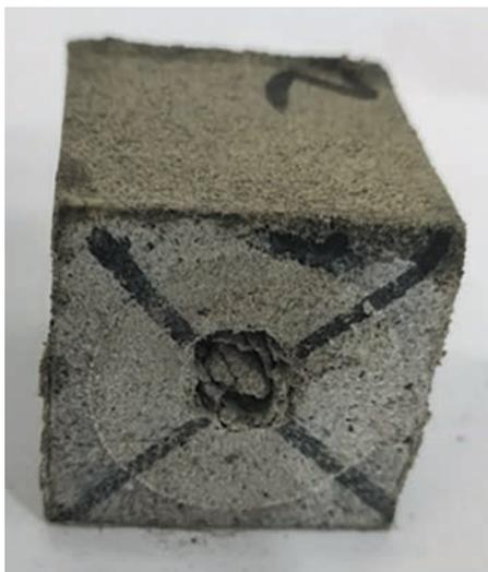
Рис. 1. Образец В5 с отверстием, соосным оси керна.
