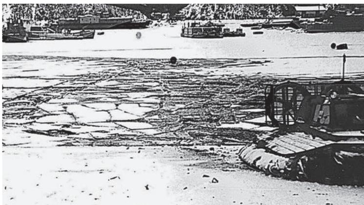
Рис. 5. Разрушение ледяного покрова СВП береговой охраны “Гепард”.
