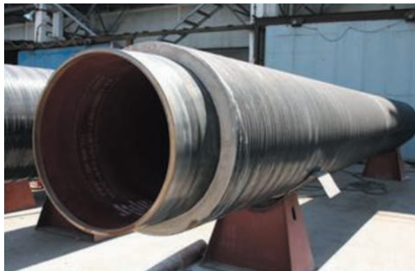
Рис. 1. Внешний вид обетонированной трубы.
