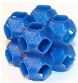
Рис. 10. Напечатанная сглаженная модель пористого материала, полученная из каркаса SOD Fig. 10. Printed smoothed porous material model obtained from the SOD framework
