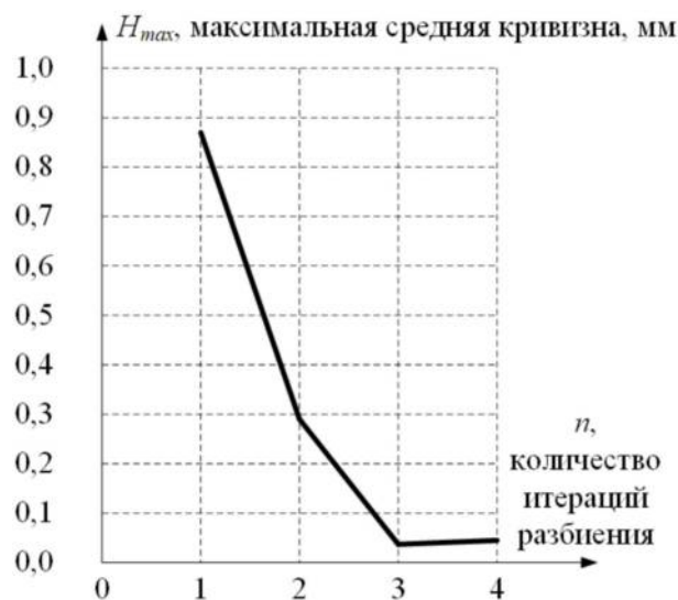
Рис. 8. График расчета максимальной средней кривизны для поверхности, полученной из каркаса SOD Fig. 8. Graph of the calculation of the maximum average curvature for the surface obtained from the SOD wireframe
