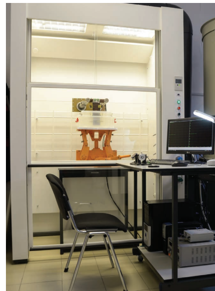
Рис. 2. Установка для измерения остаточных напряжений механическим методом УДИОН-2
