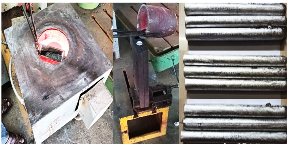
Рис. 1. Подготовка образцов Al7075 с различным упрочнением методом механического замешивания частиц в расплав
