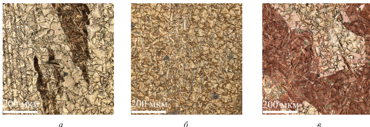
Рис. 8. Изображения поверхности образцов бронзы БрКМц 3-1 с добавлением 10 вес. % Al (а), 10 вес.% Al-5Si (б) и 10 вес.% Al-12Si (в) после коррозионных испытаний
