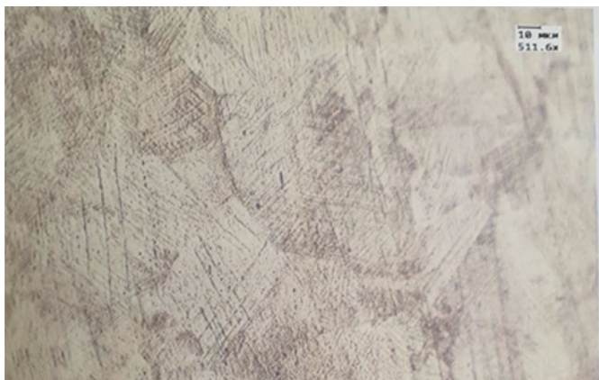
Рис. 2. Возникновение мартенситной \alpha -фазы в стали 12X18H10T, пруток Ø4 мм
