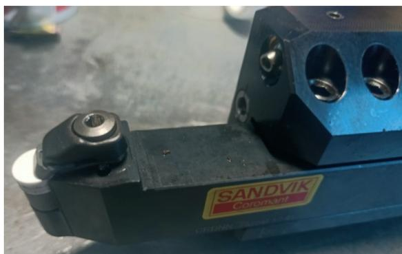
Рис. 2. Внешний вид оправки с закрепленной керамической пластиной
