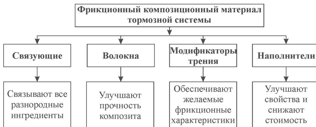
Рис. 1. Ключевые функции основных компонентов фрикционных композитов тормозных систем
