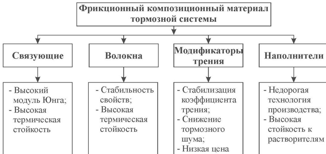
Рис. 2. Ожидаемые свойства компонентов фрикционных композитов тормозных систем
