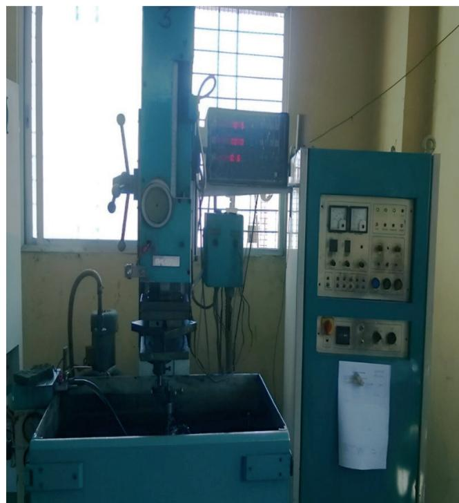
Рис. 1. Электроэрозионный копировально-прошивочный станок
