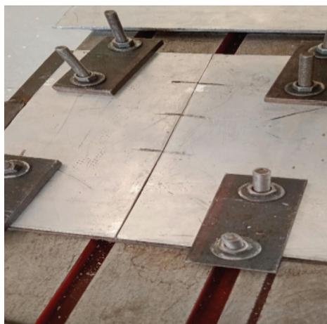
Рис. 1. Пластины, закрепленные на столе вертикально-фрезерного станка
