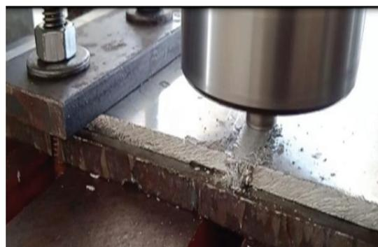
Рис. 2. Пластическое течение материала в процессе СТП
