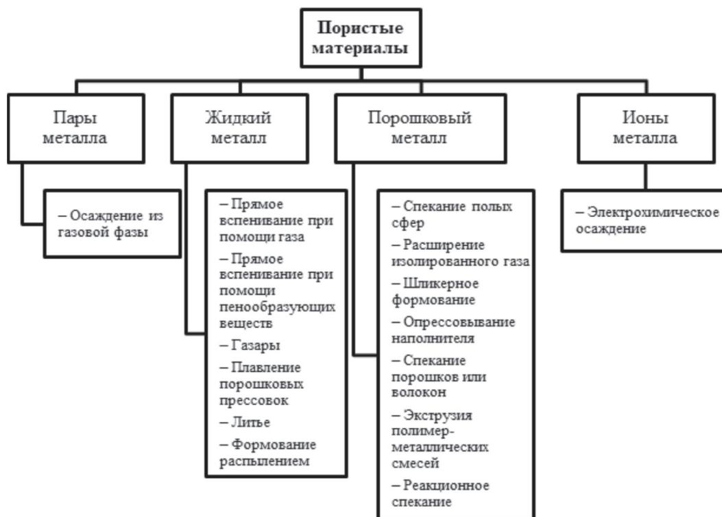
Рис. 1. Способы получения металлической пены [3]
