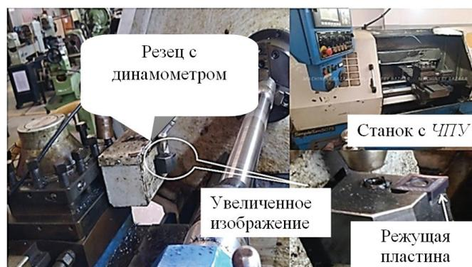
Рис. 1. Экспериментальная установка
