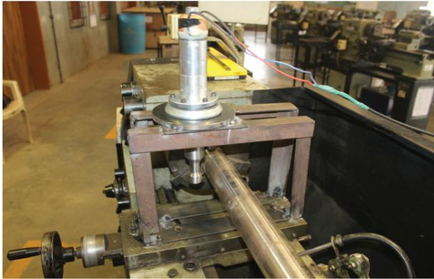
Рис. 4. Реальная фотография базовой рамы с закрепленным UVАНТ
