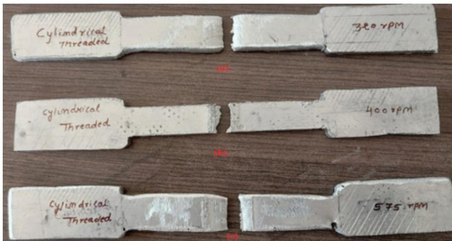
Рис. 5. Разрушенные образцы после испытания на растяжение соединений, полученных с использованием инструмента с наконечником в форме цилиндра с резьбой
