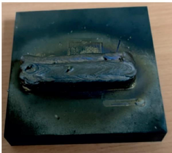
*Рис. 3.* Образец, полученный с помощью электронно-лучевой наплавки проволокой из стали 40X13
