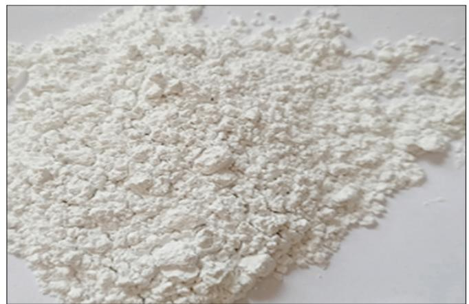
Рис. 1. Общий вид частиц карбоната кальция, используемых в качестве пенообразователя
