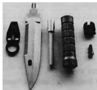
Рис. 15. Штык-нож M9 в разобранном виде
