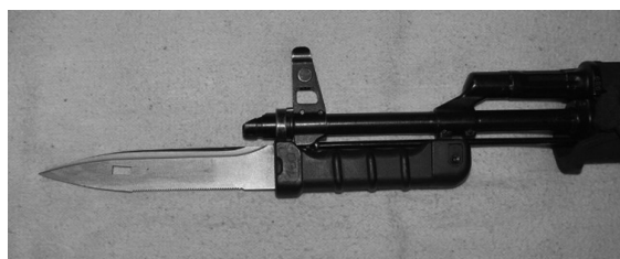
Рис. 17. Монтаж штык-ножа 6Х5 на стволе
