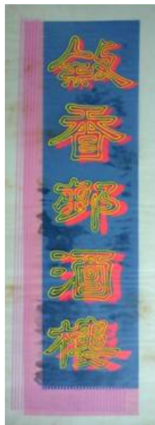
Рисунок 2. Рисунок гуашью на вывеске с полупрозрачным покрытием, показывающим расположение неоновых трубок
