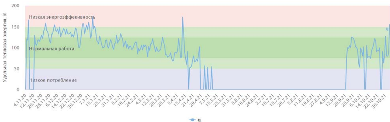
Рис. 6. График относительного удельного теплопотребления рассматриваемой системы здания Fig. 6. Graph of the relative specific heat consumption of the building system under consideration
