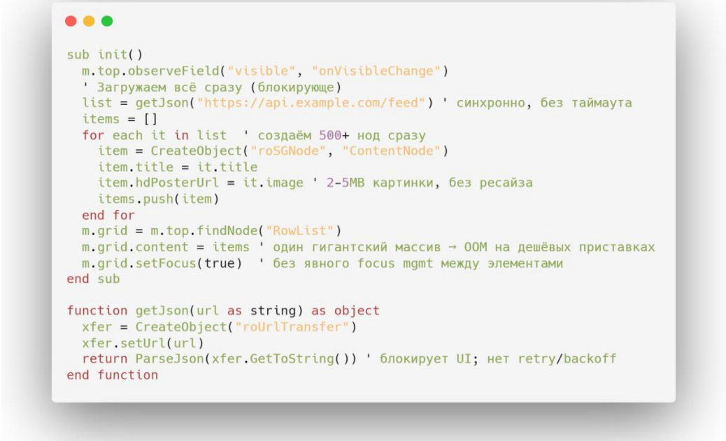
Рис. 3. Пример синхронной архитектуры интерфейса Smart TV-приложения на BrightScript (нативный SDK Roku). Fig. 3. Example of a synchronous interface architecture of a Smart TV application developed in BrightScript (native Roku SDK).
