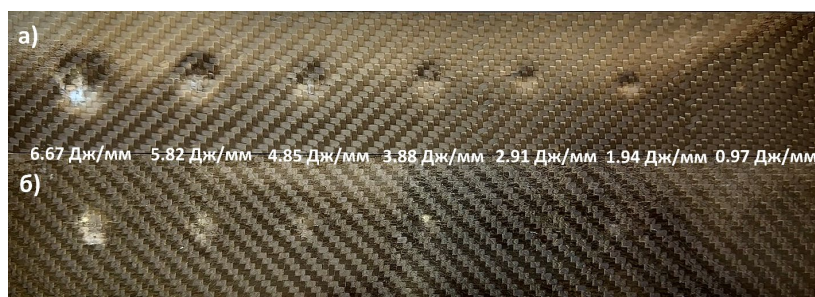
Рис. 5. Фотография образцов ПКМ на основе эпоксидного препрега T107 (а) и препрега T107 с добавлением полиамидного нетканого материала (б) после испытания на сопротивление повреждению при ударе падающим грузом со стороны удара.
