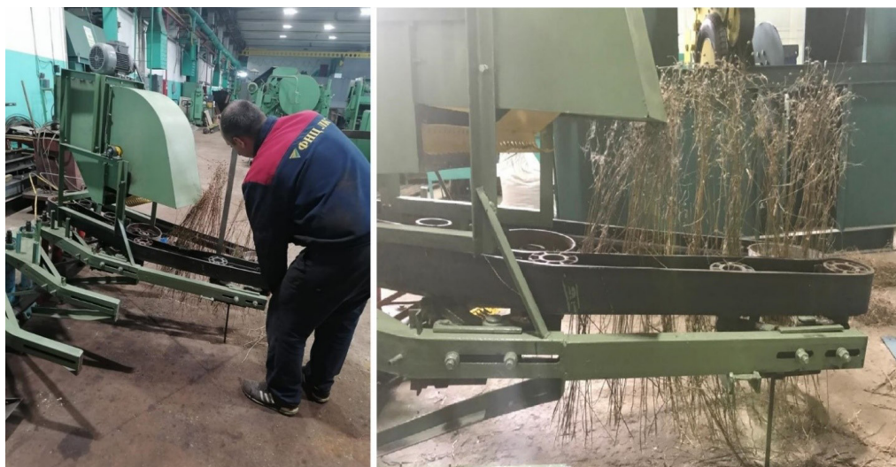
Р и с. 6. Установка стеблей льна-долгунца для проведения эксперимента F i g. 6. Installation of flax stems for conducting an experiment
