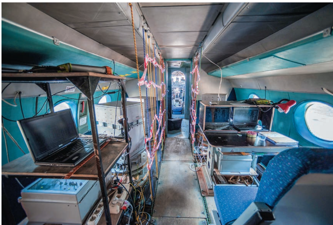
Рис. 1. Аэрогравиметрическая лаборатория на борту АН-26БРЛ.
