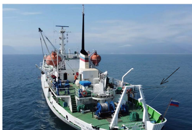
Рис. 2. Фото НИС “Профессор Водяницкий”, показывающее буксировочные приспособления сейсмической аппаратуры. Стрелкой показана буксировочная штанга “Выстрел”
