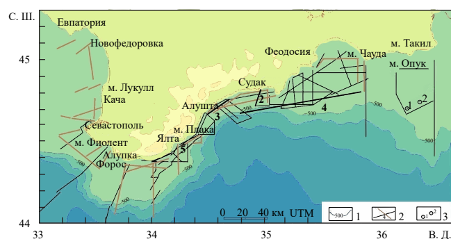
Рис. 1. Схема работ НИС “Профессор Водяницкий” в 2018–2023 гг. 1 – изобаты; 2 – сейсмоакустические профили НСАП комплекса “Геонт-шельф” (чёрный цвет) и акустические профили профилографа АП-5Т (коричневый цвет); 3 – скважины инженерно-геологических изысканий (ИГИ)
