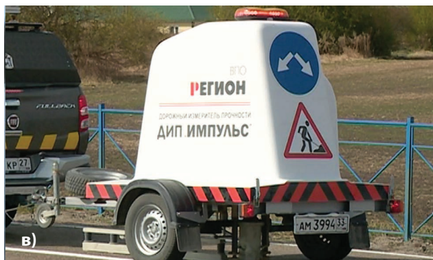
Рис. 1. Оборудование для оценки прочности дорожных одежд автомобильных дорог: а) длиннобазовый рычажный прогибомер; б) установка динамического нагружения «Дина-4»; в) установка «ДИП Импульс»; г) универсальный диагностический комплекс типа «УДК»
