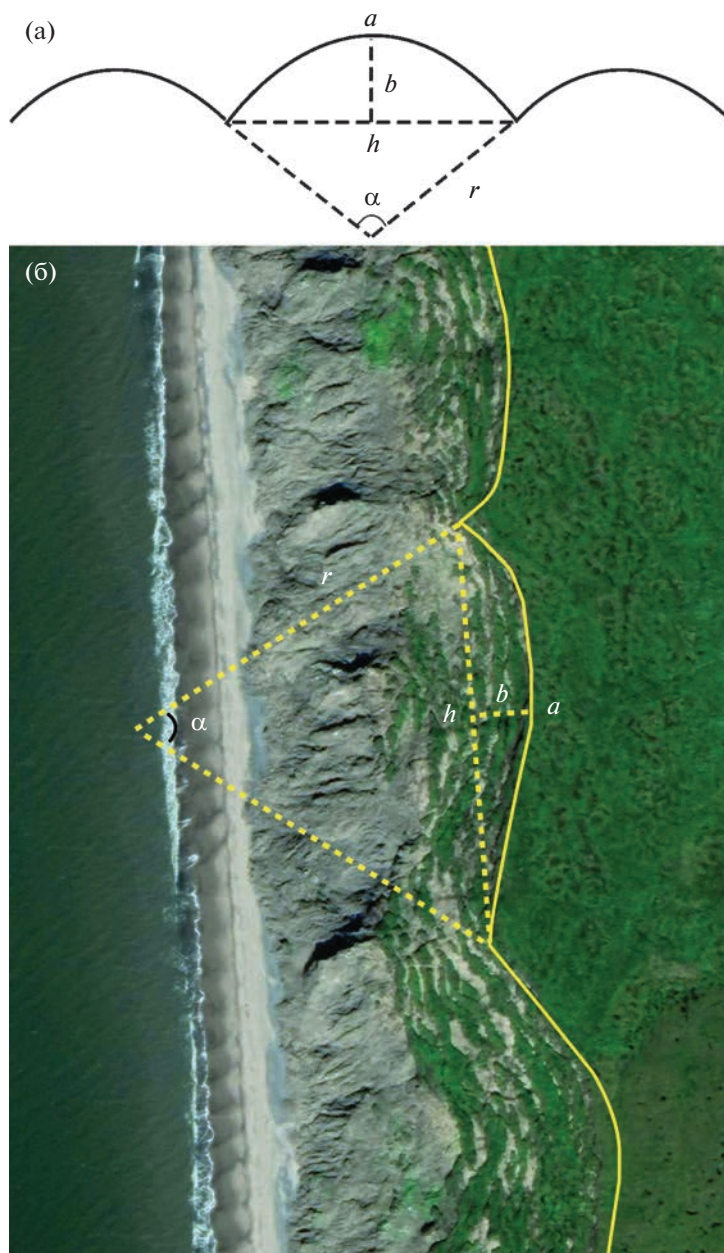
Рис. 3. Схема анализируемых характеристик (а) и их отображение на снимке (б): a — дуга, h — хорда, b — стрелка дуги, \alpha — центральный угол, r — радиус кривизны дуги.
