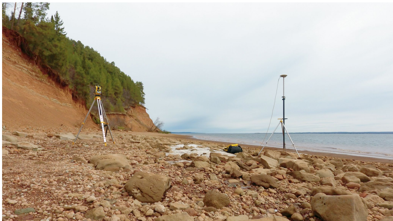
Рис. 2. Работа навигационного оборудования на реперных точках.
